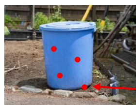
底、側面にドリルで穴を開ける
